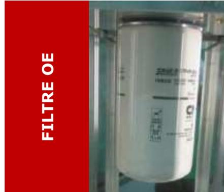
**N'a subi aucune défaillance et a atteint une pression de rupture très élevée de 30 bar lorsque le test a été interrompu manuellement.**
